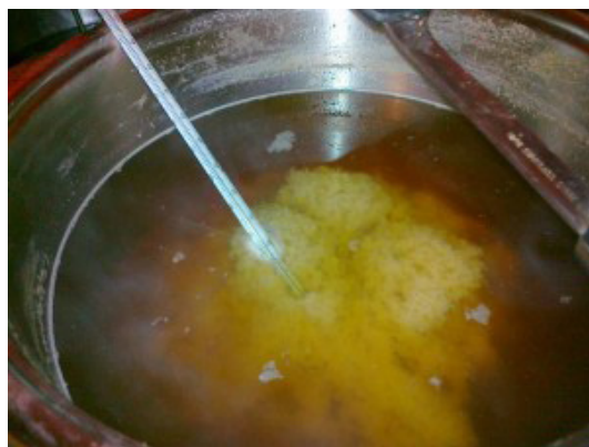
Tie baltie, katla vidū, ir proteīni, kas straujas dzesēšanas rezultātā savēlušies kunkuļos. Mīsa ir nodzidrinājusies
