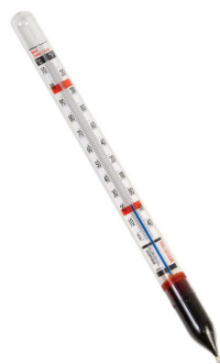
Stikla termometrs, paredzēts īpaši brūvēšanai. Iemests šķidrumā, pateicoties smagumam tā lejasdaļā peldēs ar vienu galu uz augšu, tā, ka to varēs bez problēmām izvilkt.
